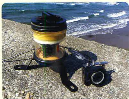
(写真5) 自作水中カメラ1号機(左)と最新の35号機(右)
