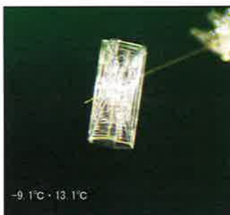
Murai式人工雪装置で作った人工雪結晶。 右は樹枝状六角結晶、左は角柱状結晶
