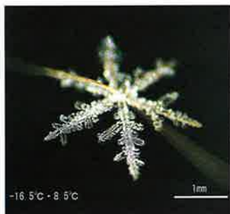
Murai式人工雪装置で作った人工雪結晶。 右は樹枝状六角結晶、左は角柱状結晶
