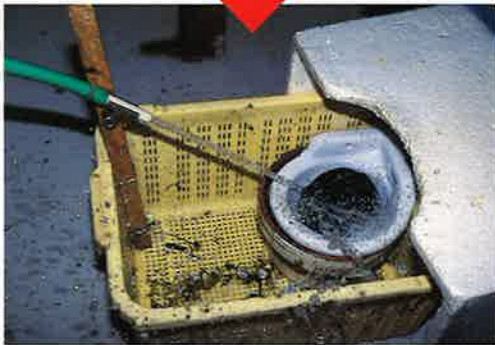
上：ボールに便がからまるしくみ 下：これぞ「便自動取り除き装置」! 水流でボールが回転、遠心力で便が取れます
